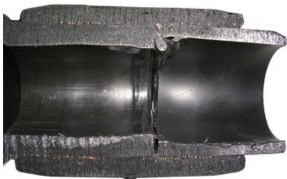
Рис.14 Недостаточный ввод одной из труб
