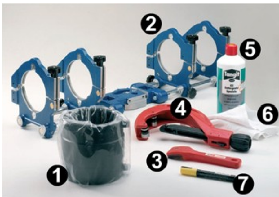
Рис.2 Принадлежности для приварки соединительной муфты
