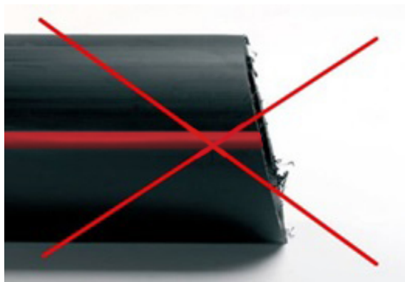
Рис.3 Неправильная обрезка трубы
