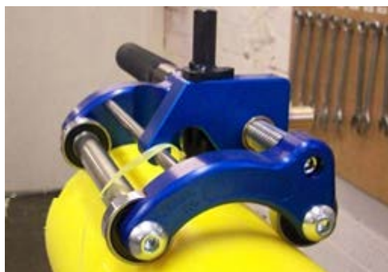
Рис.7 Очистка роликовым скребком
