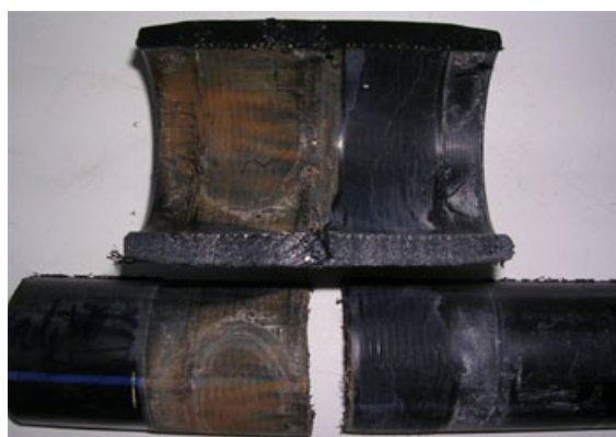
Рис.9 Расслоение трубы и фитинга
