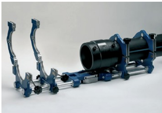
Рис.17 Фиксация первой трубы
