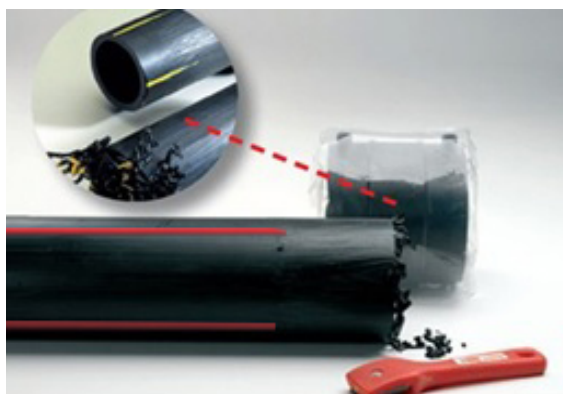
Рис.6 Очистка ручным скребком
